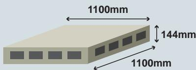
コンテナパレットサイズ(JIS Z 0601) 縦1100mm×横1100mm×高さ144mm
