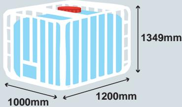
IBCコンテナサイズ(1200ℓ) 幅1000mm×奥行1200mm×高さ1349mm
